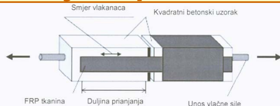
Slika 2.4. Ispitivanje čvrstoće prijanjanja na betonskom uzorku ojačanom FRP tkaninom
