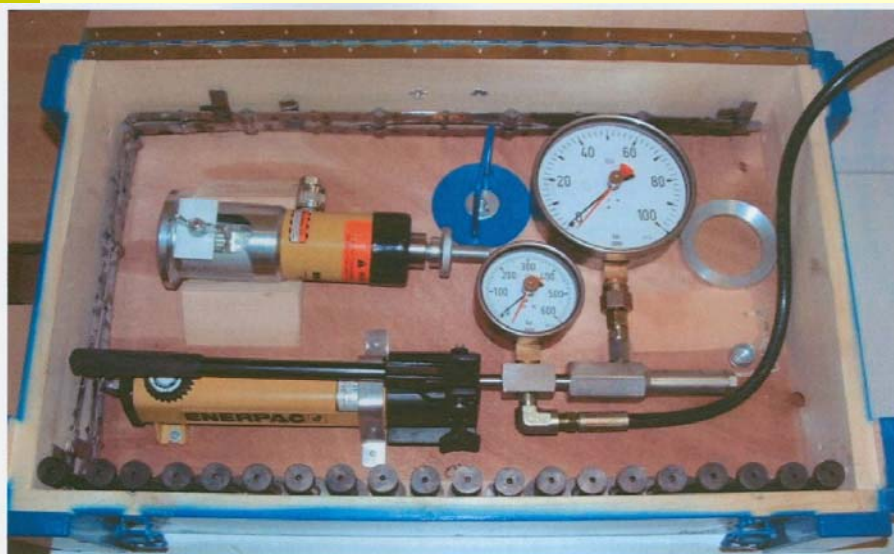
Slika 74. Mjerni instrument za razna ispitivanja betona – pull out
